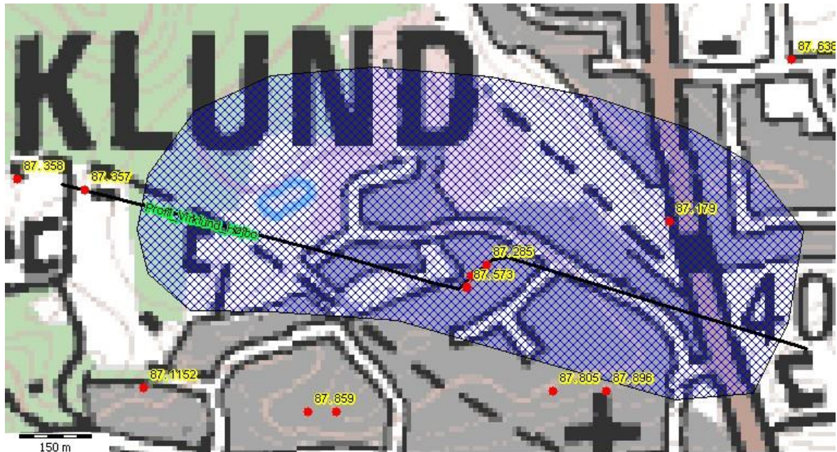
Figur 5.1 Boringer og indvindingsopland omkring Virklund Højbo Vandværk. Boringer er angivet med en stor rød prik og DGU nr. Det skraverede område er indvindingsoplandet. Den sorte linje viser forløbet af profilsnittet på Figur 5.2. Legende med farvekode kan ses i bilag 8.3.
